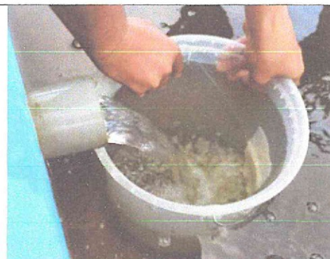
Imagen n.º 20: Aforo del caudal en la PTAP utilizando un balde graduado.
