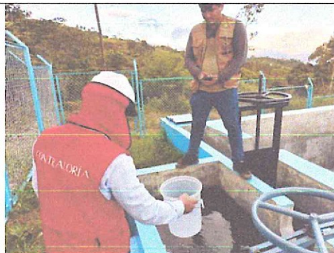
Imagen n.º 18: Procedimiento de medición del caudal en el punto de llegada de la línea de conducción al filtro lento.
