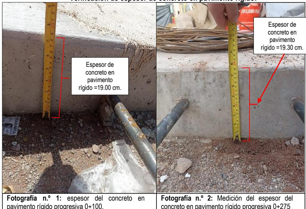
**Fotografía n.º 1:** espesor del concreto en pavimento rígido progresiva 0+100,
