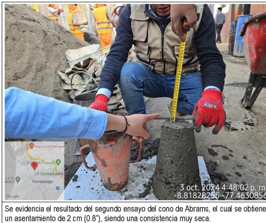
Se evidencia el resultado del segundo ensayo del cono de Abrams, el cual se obtiene un asentamiento de 2 cm (0.8"), siendo una consistencia muy seca.
