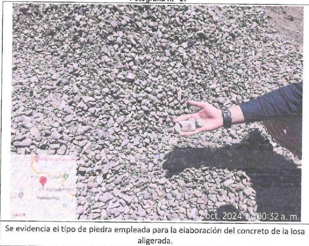
Se evidencia el tipo de piedra empleada para la elaboración del concreto de la losa aligerada.
