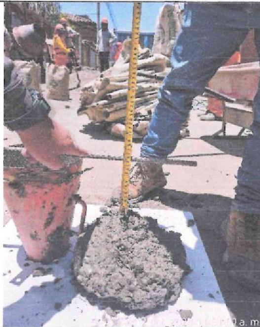
Se evidencia el resultado del primer ensayo del cono de Abrams, el cual se obtiene un asentamiento de 15 cm, siendo una consistencia fluida .
