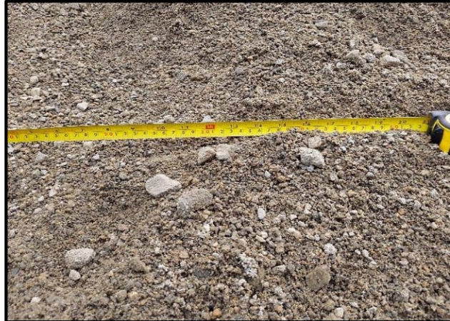
FOTOGRAFÍA N° 15 AGREGADO FINO QUE CONTIENE GRAVAS DE 1,5 CM
