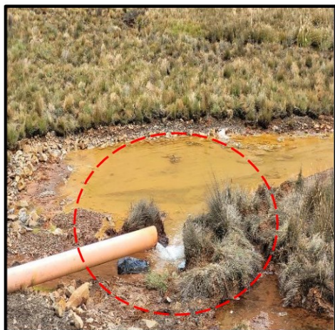
FOTOGRAFÍA N° 9 DESCARGA DE DRENAJE ÁCIDO DE LA BOCAMINA ID 5032 A LA QUEBRADA SIN NOMBRE
