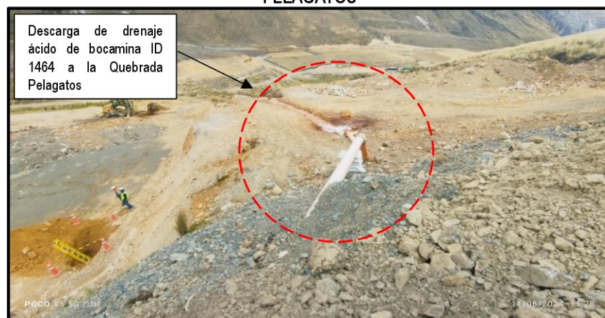
IMAGEN N° 5 DESCARGA DE DRENAJE ÁCIDO DE LA BOCAMINA ID 1464 HACIA LA QUEBRADA PELAGATOS
