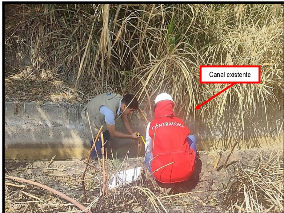
FOTOGRAFÍA N° 1 VERIFICACIÓN DE MEDIDAS DE SECCION TRANSVERSAL - CANAL SAN DIEGO EXISTENTE
