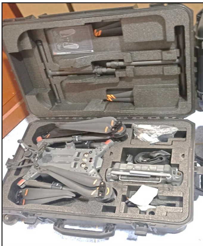
Fotografía n.º 22: Se observa el Vehículo aéreo no tripulado (DRONE) Multirrotor RTK, batería dual, topográfico, para áreas medianas modelo MATRICE 350 RTK.
