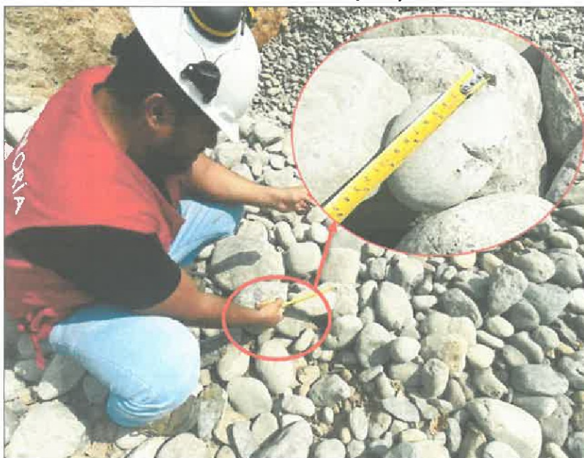
Fotografía n.º 3 Dimensiones del material pedraplén
