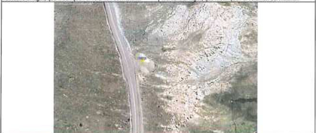
Imagen n.º 5: Imagen satelital de Google Earth del DME-5 de junio de 2023, en la cual observa montículos de material excedente; asimismo, no se observa afluentes de agua cercano al lugar, que modifiquen el volumen del material.
