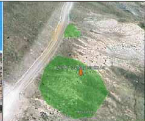
Imagen fotográfica n.º10: DME-5 ubicado a aproximadamente 50 m respecto del área establecido según la DIA y planos del expediente técnico, ubicada en KM 34+730 (a lado izquierdo de la carretera), en las coordenadas UTM, N: 8555401,589; E: 455406,689, se evidencia rocas de gran tamaño y área donde debió estar ubicado el DME.
