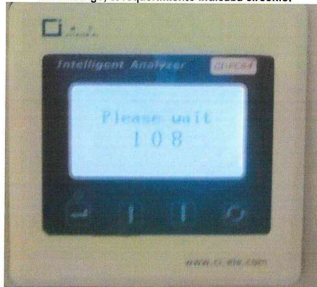
Toma Fotográfica n.º 11 Analizador de oxígeno "Intelligent Analyzer CI-PC84", con sensor de oxígeno de flujo de iones, sin embargo, el requerimiento indicaba circonio.
