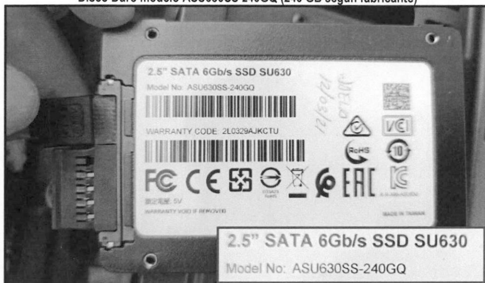
Imagen n.º 45 Disco Duro modelo ASU630SS-240GQ (240 GB según fabricante)
