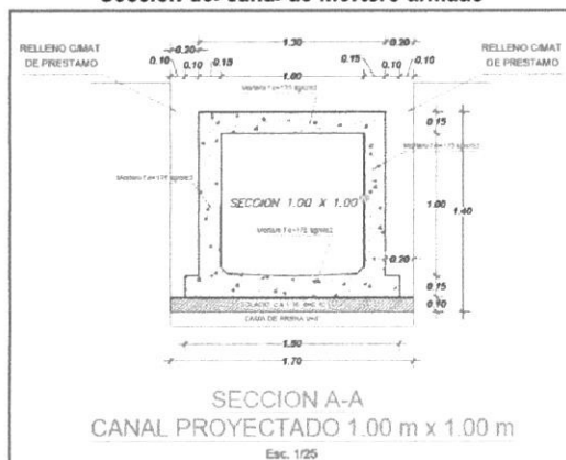
Imagen n.° 38 Sección del canal de mortero armado
