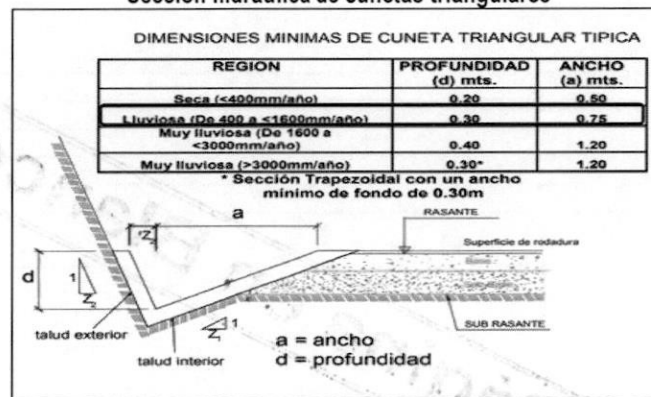
Imagen n.° 8 Sección hidráulica de cunetas triangulares
