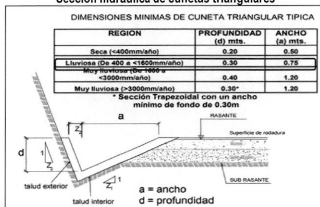
Imagen n.º 10 Sección hidráulica de cunetas triangulares
