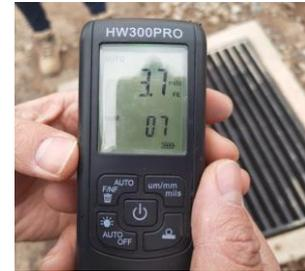
RESULTADO DEL ESPESOR DE PINTURA 3.7 MILS
