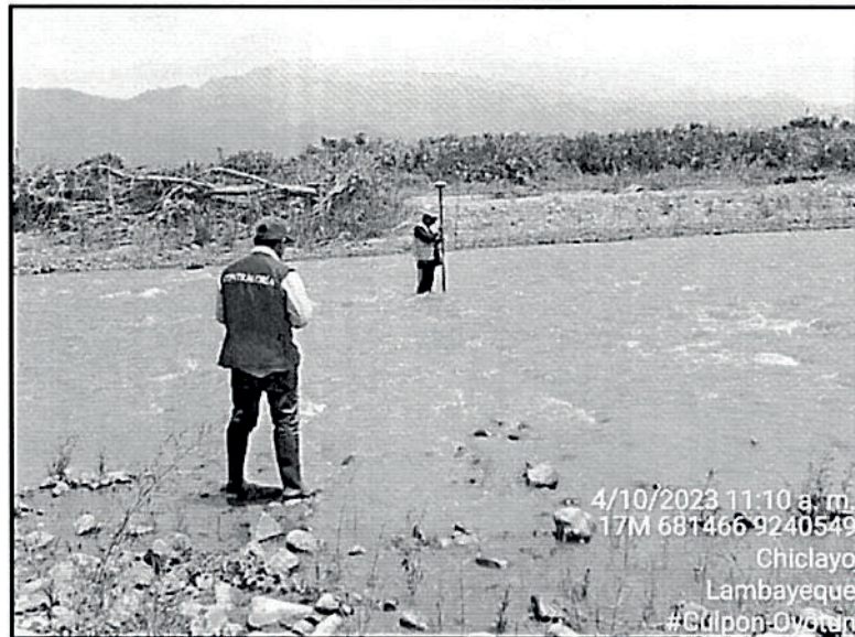
IMAGEN N°02: EQUIPO GNNS DIFERENCIAL TOMANDO LECTURA DE PUNTOS EN EL RIO ZAÑA SECTOR CULPON
