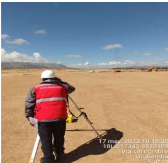
Toma de mediciones con nivel topográfico, para obtener la medición de los asentamientos en el subsector T4A-R-2.
