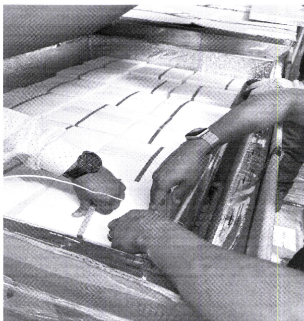
Personal del almacén de productos termosensibles del CENARES colocando data logger en la parte superior de la caja térmica n.º 39 Fecha: 24 de marzo de 2023
