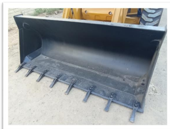
Imagen n.º 5 Cucharon frontal de retroexcavadora no cuenta con placa de datos
