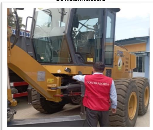
Imagen n.º 32 Inspección de componentes de sistema hidráulico De motoniveladora
