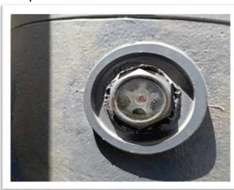
Imagen n.º 39 Caja de reductores de tornamesa, no tiene aceite según lo que se visualiza en su indicador de nivel de aceite
