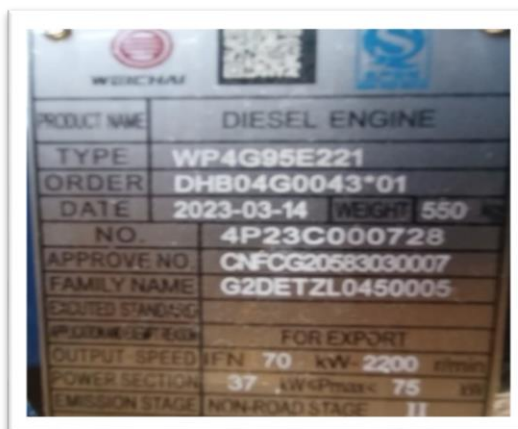
Imagen n.º 9 Placa de identificación de motor de Retroexcavadora LOVOL modelo FLB468-II
