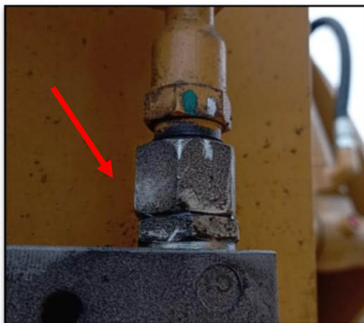
Imagen n.º 16 Retroexcavadoras con serie N° CLW009LDTPN001767, presenta fuga de aceite hidráulico en conexión de manguera de estabilizadores
