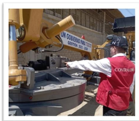
Imagen n.º 38 Inspección de componentes de tornamesa de Motoniveladora
