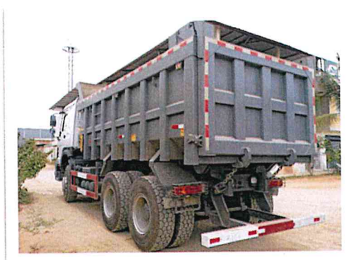
Imagen n.º 5 Inspección de parte posterior de tolva, no cuenta con placa de datos.
