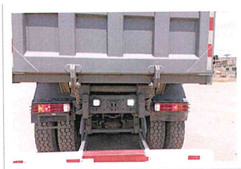
Imagen n.º 8 Inspección de parte posterior de tolva, no cuenta con placa de datos
