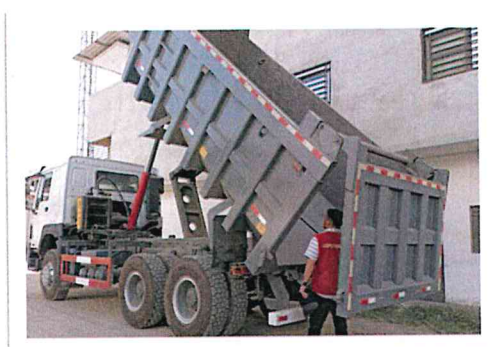
Imagen n.º 7 Inspección de parte interior de tolva, no cuenta con placa de datos
