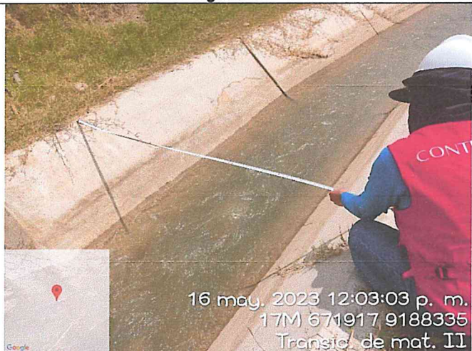
Se tomó el ancho del canal, obteniéndose una medida de 2.40 m.
