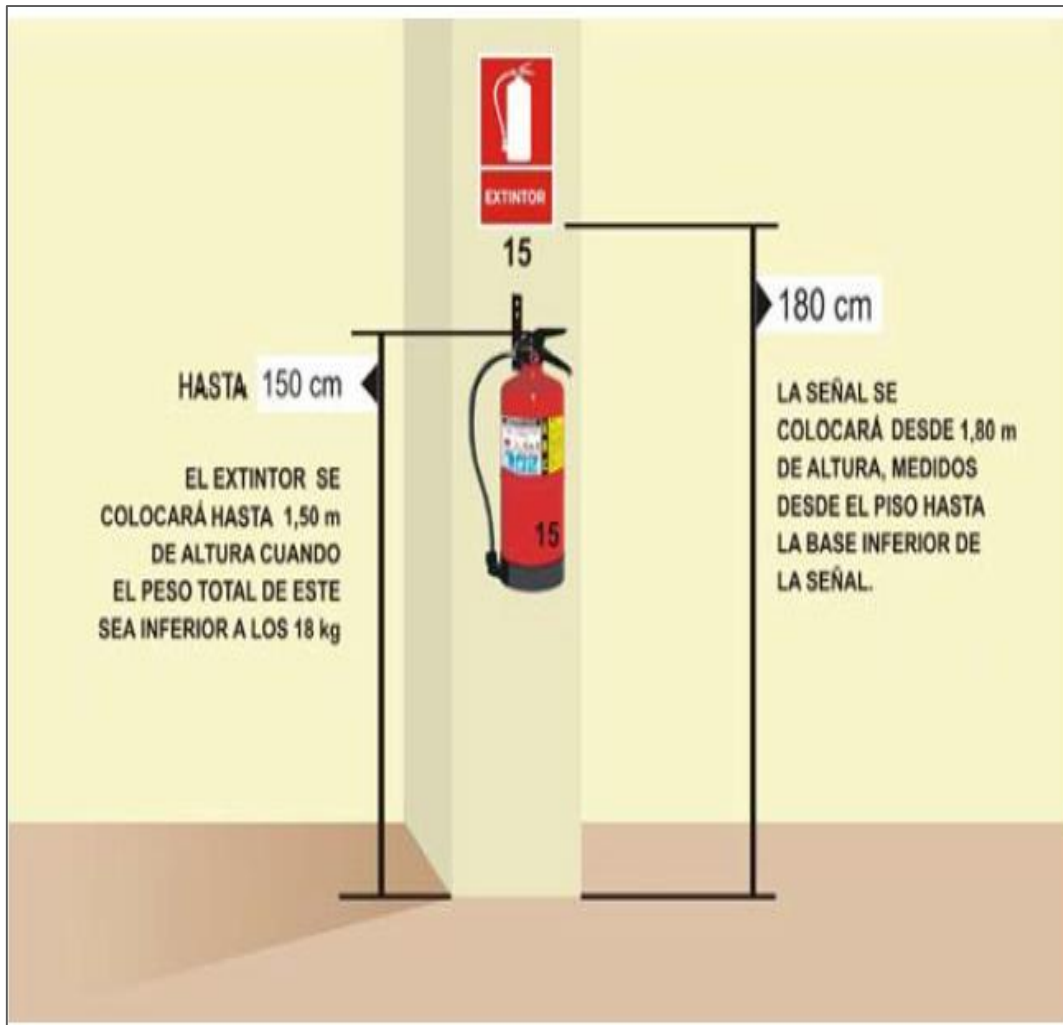
(Fig. 8), Altura de la Instalación de Extintor, igual o menor de 18kg. (NTP 350.043-1:2011)
