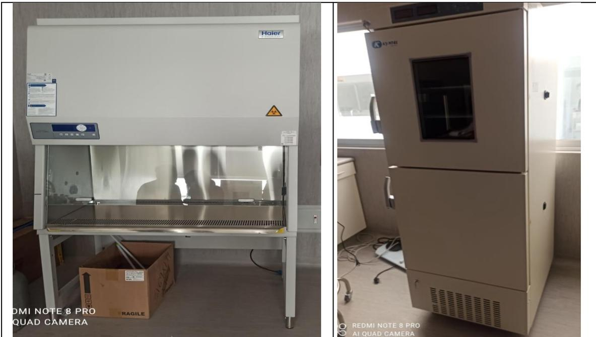
**Descripción:** Al lado izquierdo se muestra la cabina de flujo laminar vertical inoperativo por falta de instalación, programación y capacitación, y a la derecha se muestra refrigerador inoperativo por falta de instalación y carencia de tomacorrientes.
