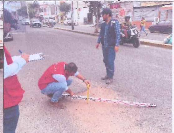
Descripción: Superficie (2.700 m 2 ), la profundidad del hueco es de 0.075 m. Se advierte relleno de material reciclado realizado por los pobladores.
