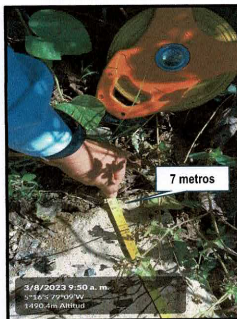
Imagen n.º 7 Medida del Baden in situ Tramo Bajo Ihuamaca – La Estrella
