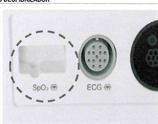
Fotografía n.º 2: Vista de la entrada de sensores de transductores donde se aprecia que el equipo no cuenta con el conector de la troncal para conectar el sensor que mide la saturación.
