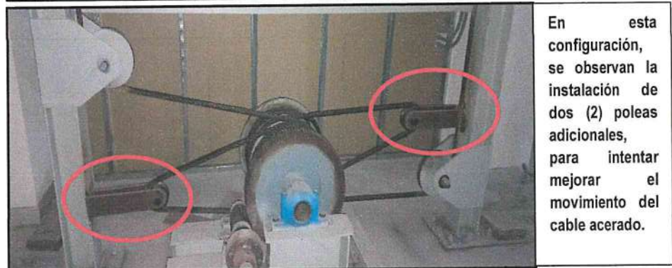
IMAGEN N° 16 DETALLE DE GIRO DE TAMBOR VS POLEA
