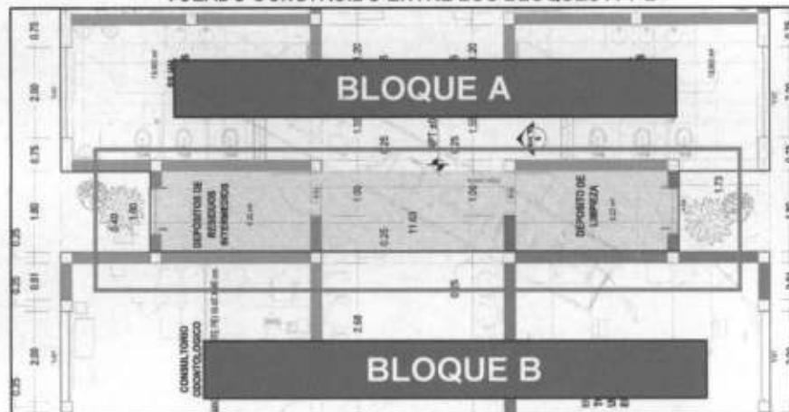
IMAGEN N° 15 VOLADO CONSTRUIDO ENTRE LOS BLOQUES A Y B
