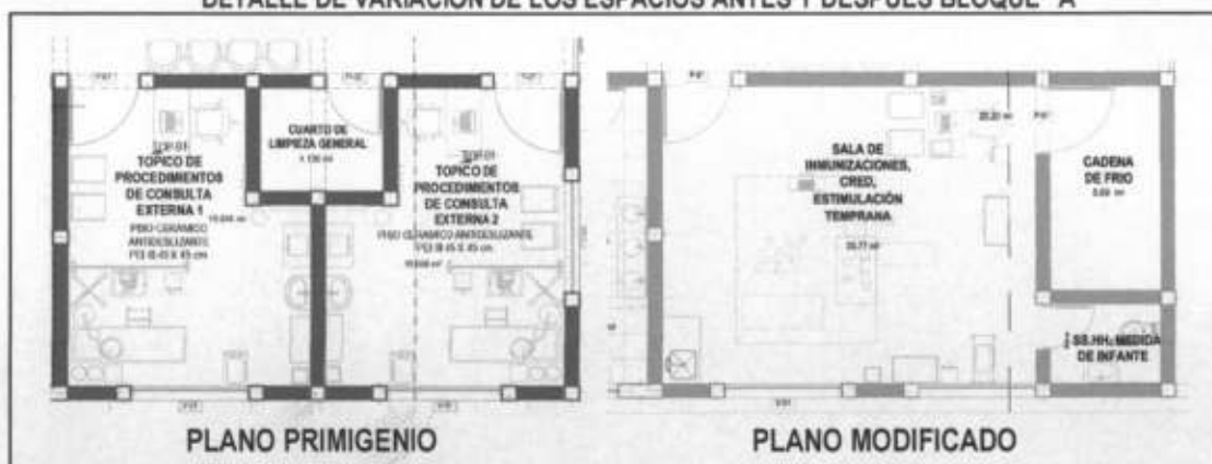
IMAGEN N° 5 DETALLE DE VARIACIÓN DE LOS ESPACIOS ANTES Y DESPUÉS BLOQUE "A"
