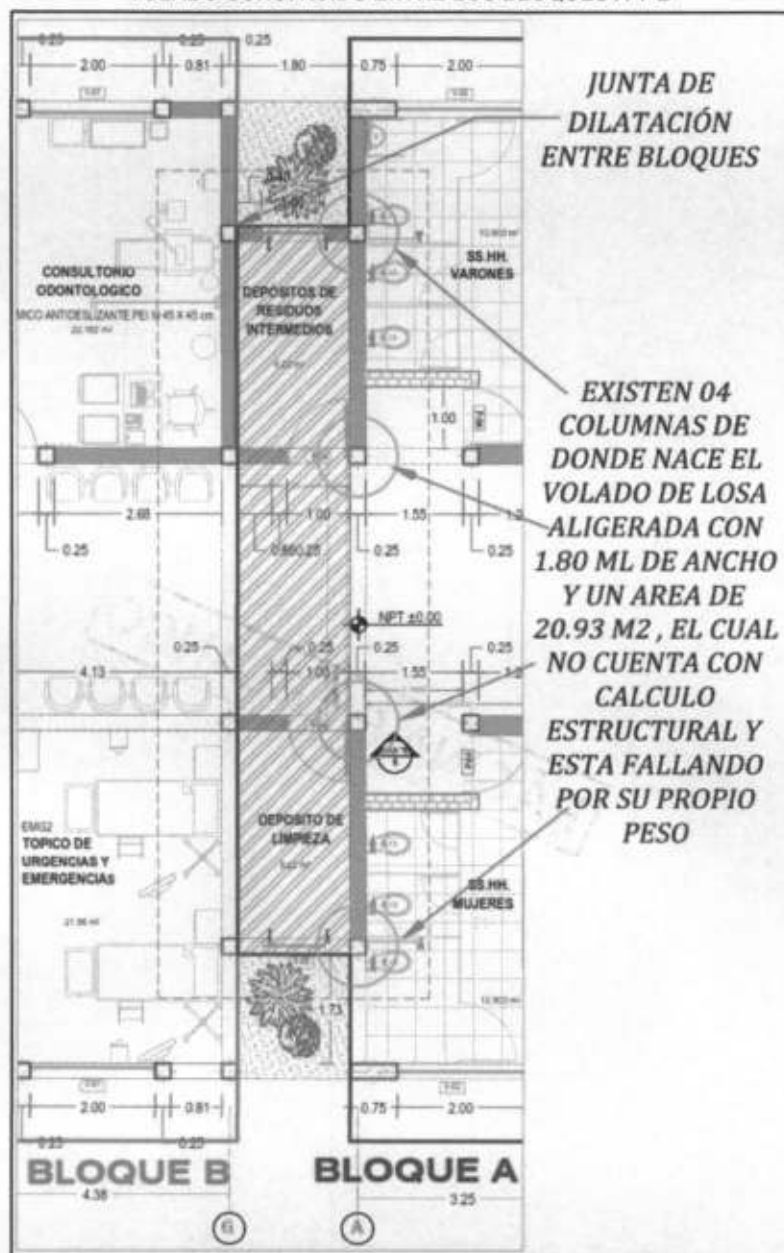
IMAGEN N° 29 VOLADO CONSTRUIDO ENTRE LOS BLOQUES A Y B
