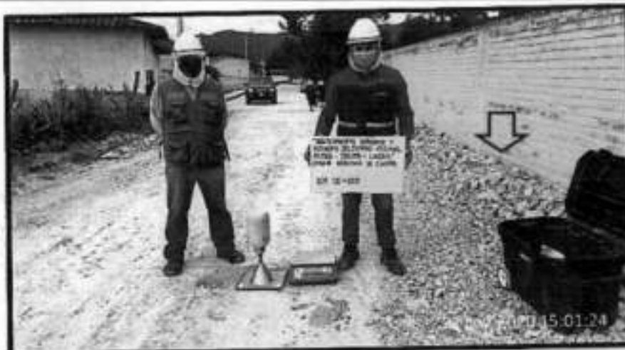
FOTO N° 42: Ensayos de densidad de suelos en el camino vecinal Matara-Jocos-Lacas
