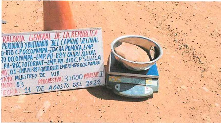
**Comentario:** Se observa agregados de gran tamaño encontrados dentro de la capa de Afirmado E=0.15m, los cuales superan el tamaño máximo de agregado requerido en las Especificaciones Técnicas que es de 2 pulgadas.
