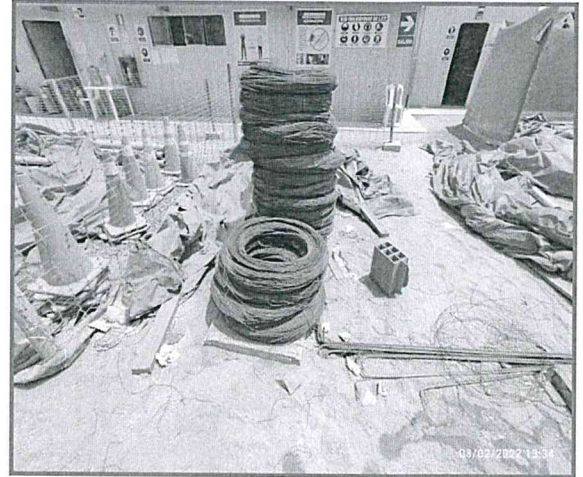
FOTOGRAFÍA N° 10 ROLLOS DE ALAMBRE N° 16 EXPUESTOS AL MEDIO AMBIENTE CON PRESENCIA DE OXIDO
