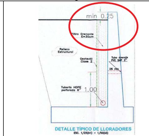
Se muestra la altura mínima de 0,25m libre que deben tener los muros hacia el relleno estructural.
