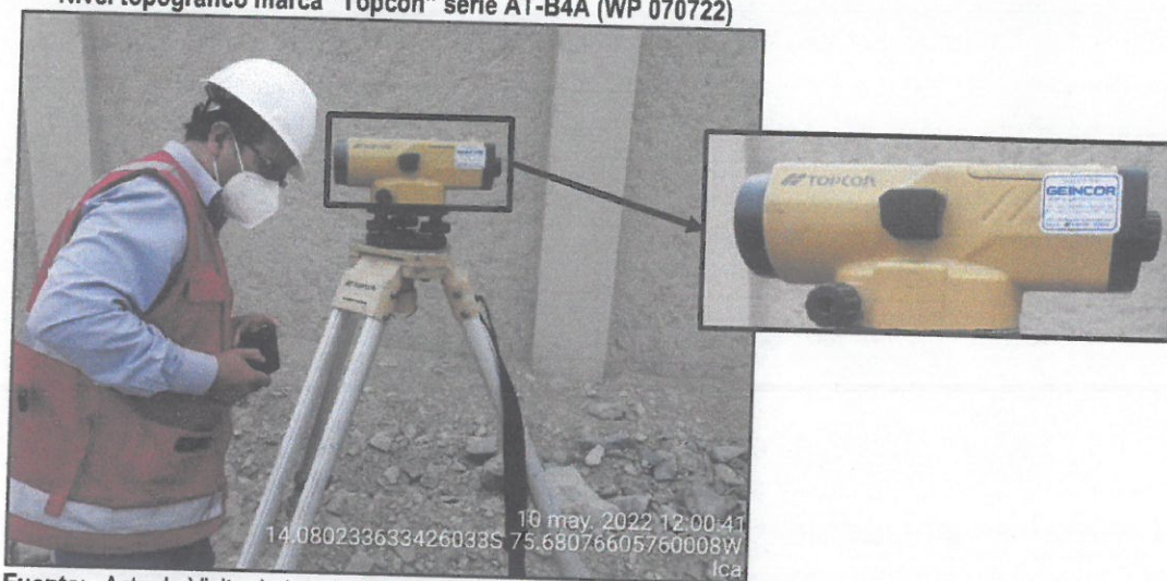
Imagen n° 15 Nivel topográfico marca "Topcon" serie AT-B4A (WP 070722)
