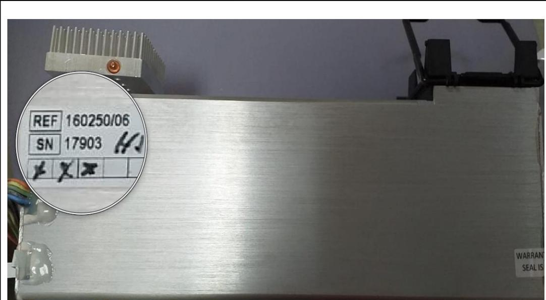
No se realizó el cambio del módulo blower, presenta año de fabricación 2006. En el formato 3 la empresa proveedora del servicio no indica entrega y cambio del módulo blower.
