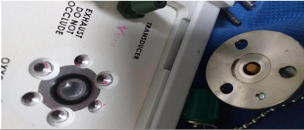
Se evidencia que entrada de oxígeno, filtro y o-ring se encuentran en buenas condiciones.
