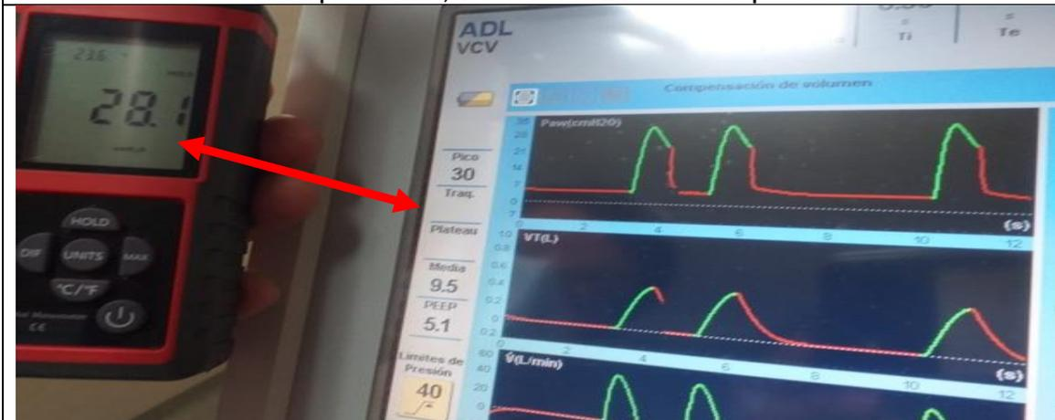
El valor de la presión pico medido por el equipo ventilador es de 30 cmH2O, y el valor pico medido por el manómetro digital de presión es de 28.1 cmH2O; por lo tanto, se encuentra alterada en 1.9 cmH2O. Se constata que no se realizó la calibración interna de los transductores de presión.
