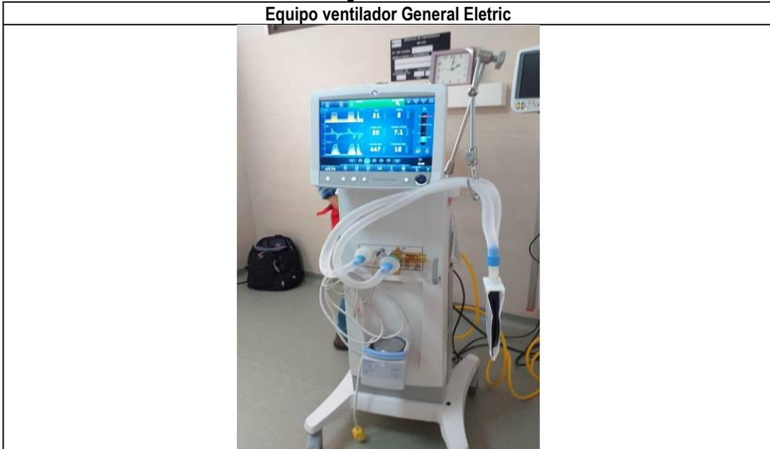
Ventilador volumétrico mecánico marca: GENERAL ELECTRIC, modelo: CARESCAPE R860, serie: CBRU02570
