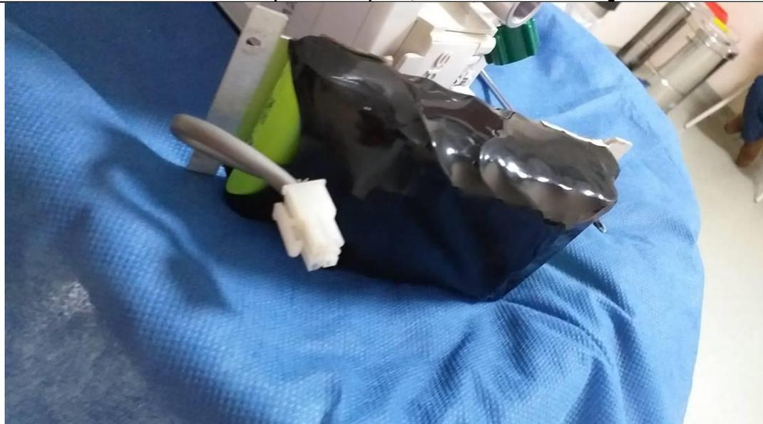
Se evidencia que pack de batería de respaldo es adaptado, no contiene sticker de seguridad con número de serie de fábrica.
