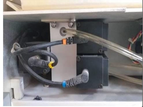
Se evidencia que parte interna del gabinete que contiene tarjeta electrónica, cooler y líneas neumáticas presentan resto de polvo acumulado
