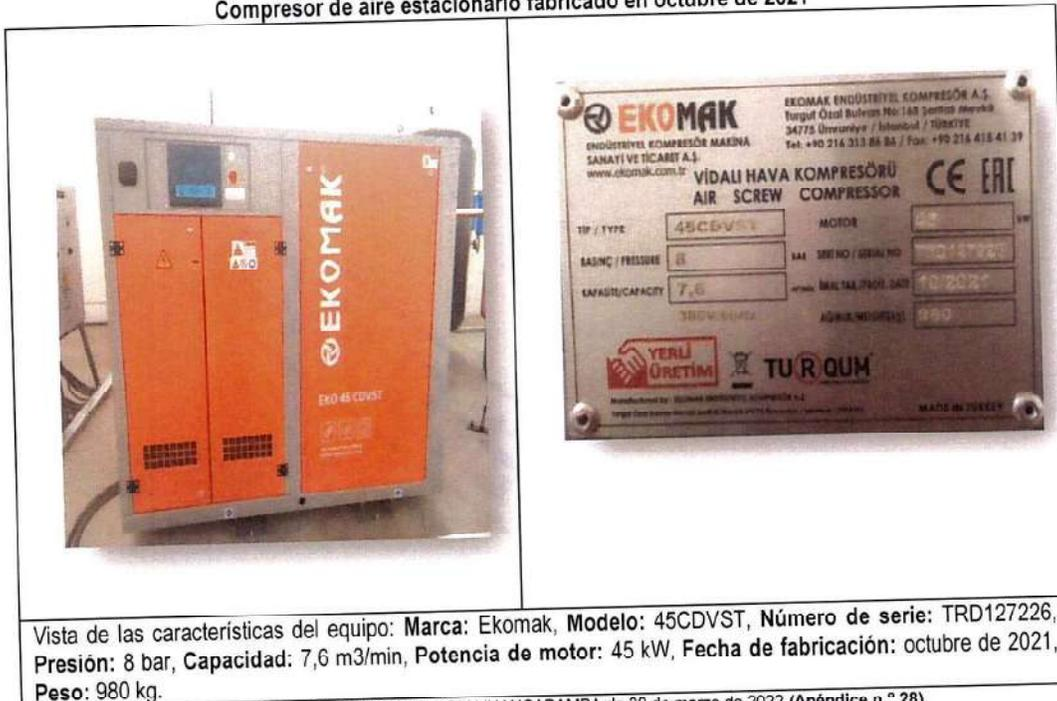
Vista de las características del equipo: **Marca:** Ekomak, **Modelo:** 45CDVST, **Número de serie:** TRD127226, **Presión:** 8 bar, **Capacidad:** 7,6 m<sup>3</sup>/min, **Potencia de motor:** 45 kW, **Fecha de fabricación:** octubre de 2021, **Peso:** 980 kg.
