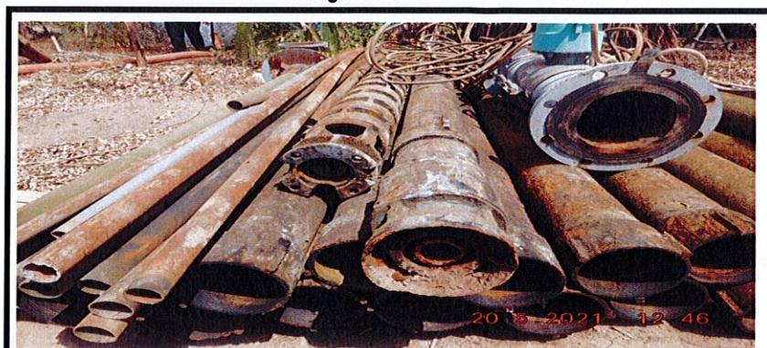
Bomba sumergible inoperativa, extraída del pozo tubular, se observa el deterioro de la columna de producción de 4", en cuanto a alta cantidad de óxido presente en las tuberías. Se observa que la bomba sumergible ha sufrido el desprendimiento del cuerpo de la bomba al motor.
