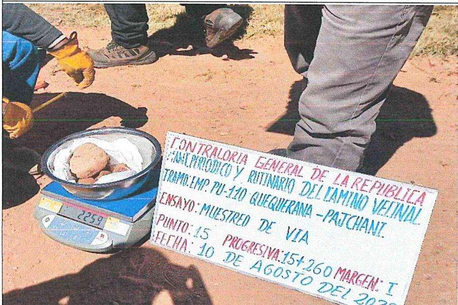
**Comentario:** Se observa agregados de gran tamaño encontrados dentro de la capa de afirmado  $e=0.15m$ , los cuales superan el tamaño máximo de agregado requerido en las especificaciones técnicas que es de 1 1/2".
