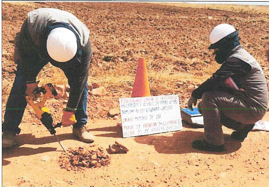
**Comentario:** Se observa agregados de gran tamaño encontrados dentro de la capa de afirmado e=0.15m, los cuales superan el tamaño máximo de agregado requerido en las especificaciones técnicas que es de 2".
