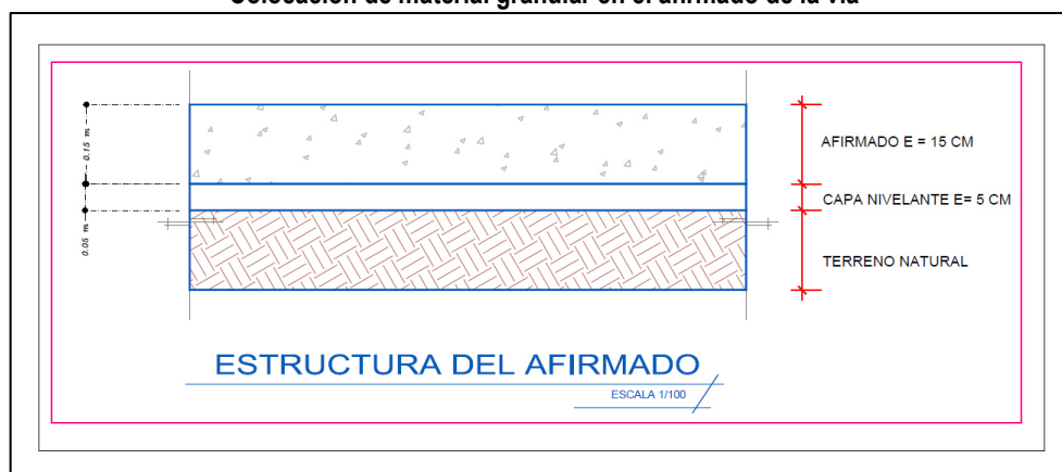
Imagen n.º 2 Colocación de material granular en el afirmado de la vía
