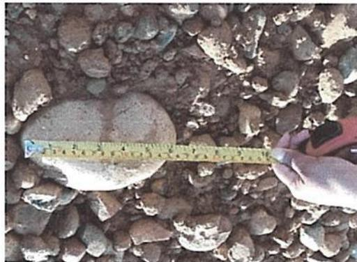
Progresiva 87+500 se observa el material de préstamo que se viene utilizando para el relleno. Se advierte material con diámetros de 6".
