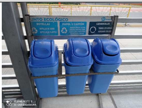
Fotografía N° 70: Vista del punto de acopio de residuos sólidos de la zona de andén – sentido sur, Estación UNI en la que se observa que no se cumple con el código de colores para la segregación y almacenamiento de los residuos, conforme al DL 1278 y la NTP 900.058-2019.
