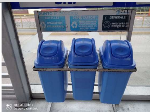
Fotografía N° 69: Vista del punto de acopio de residuos sólidos de la zona de andén – sentido norte, Estación UNI en la que se observa que no se cumple con el código de colores para la segregación y almacenamiento de los residuos, conforme al DL 1278 y la NTP 900.058-2019.
