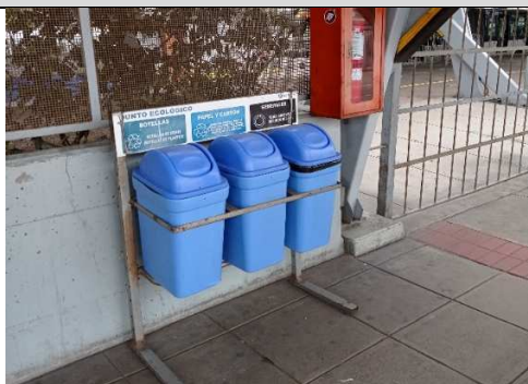
Fotografía N° 73: Vista del punto de acopio de residuos sólidos de la Zona Troncal, se observó que no se cumple con el código de colores para la segregación y almacenamiento de los residuos, conforme al DL 1278 y la NTP 900.058-2019.
