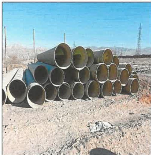
Imagen n.º 3: Tubería de PRFV de 600, 700, 800 y 1000 mm de Ø, existente de hasta 12 metros de largo.
