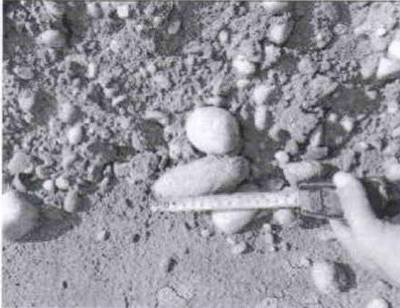
Agregado con medida de 4" colocado en OBRA para base granular (31/08/2021)
