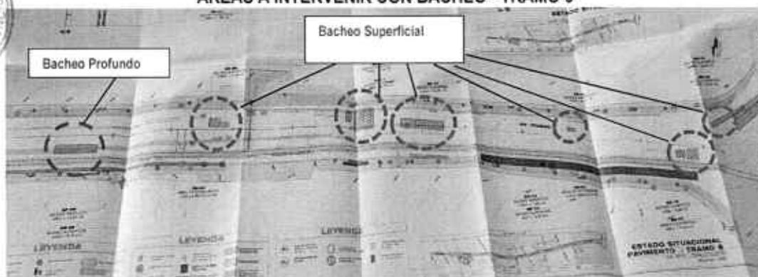
Imagen n.° 01 ÁREAS A INTERVENIR CON BACHEO - TRAMO 6
