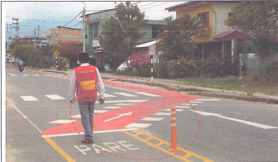
Vista de cruce en diagonal de la ciclovia del lado izquierdo hacia el lado derecho de la calzada en el Jr. Jorge Chávez C-17, no se observa señal de control de tráfico (semáforo), lo que representaría peligro para los ciclistas toda vez que la señalización vertical es insuficiente para garantizar la integridad de los usuarios.
