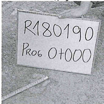
Imagen n.º 22 Material granular superior a 2" ubicado en el tramo R180190, progresiva 0+000
