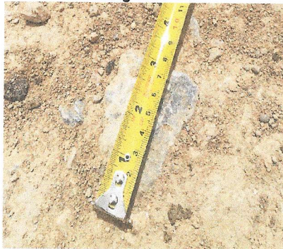
Traslape de la ruta vecinal JU-817 con vía departamental JU-113, muestra rocas mayores a dos (2) pulgadas.
