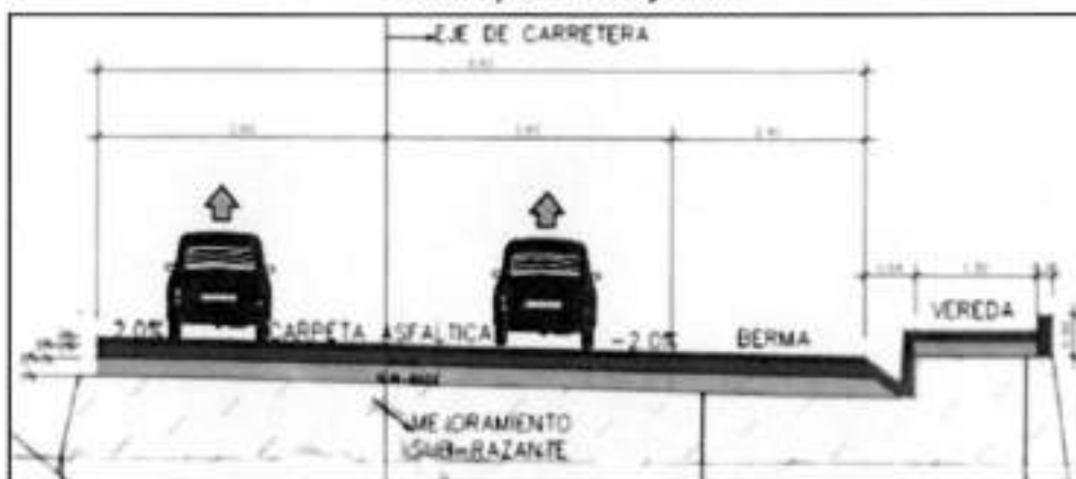
Imagen n.° 27 Sección Típica de corte y relleno
