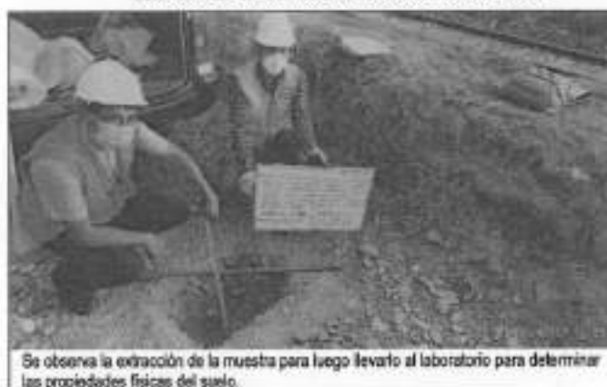
Imagen n.º 42 Extracción de muestras de suelo en la Obra
