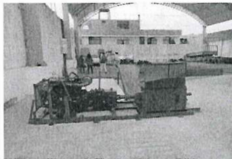
Máquina Picadora de Algas ubicada al interior de la Planta de Picado y Empaquetado de Algas.
