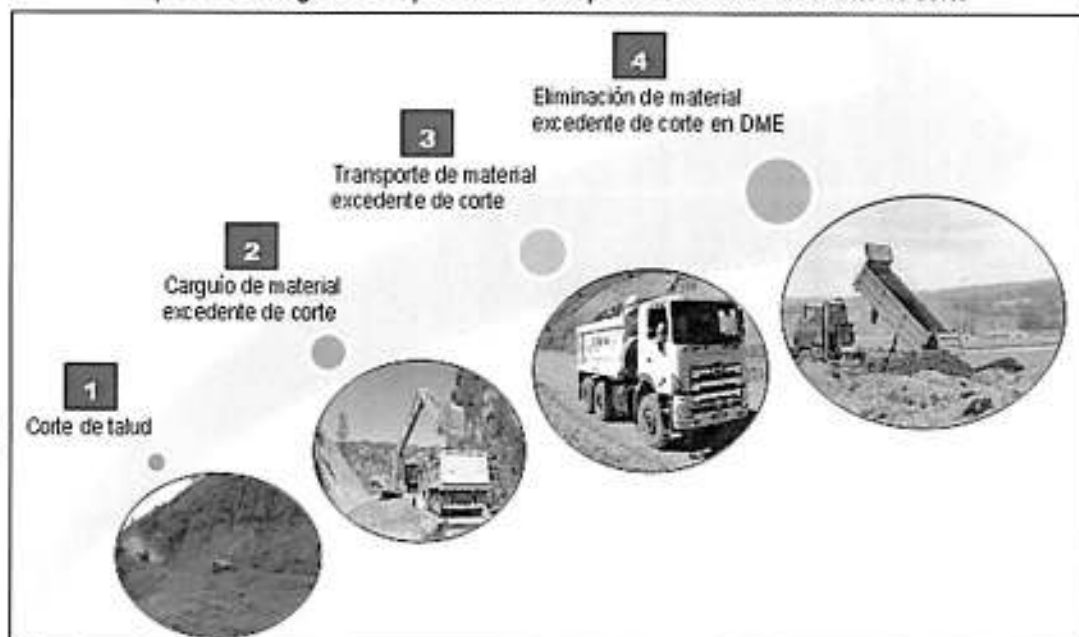
Imagen n.º 4 Representación gráfica del proceso de transporte de material excedente de corte
