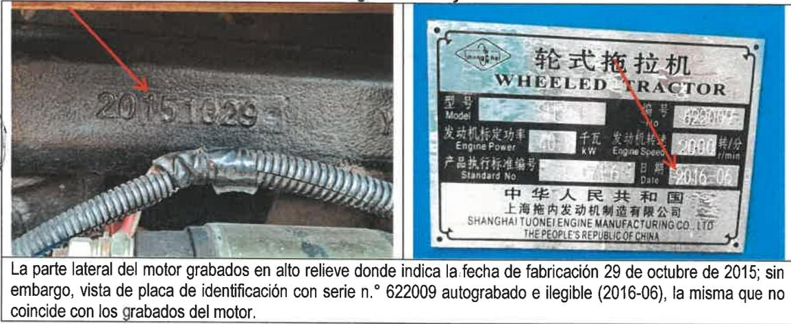
La parte lateral del motor grabados en alto relieve donde indica la fecha de fabricación 29 de octubre de 2015; sin embargo, vista de placa de identificación con serie n.º 622009 autograbado e ilegible (2016-06), la misma que no coincide con los grabados del motor.
