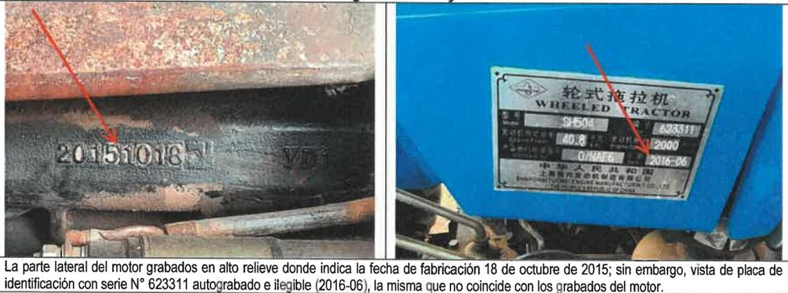
La parte lateral del motor grabados en alto relieve donde indica la fecha de fabricación 18 de octubre de 2015; sin embargo, vista de placa de identificación con serie N° 623311 autograbado e ilegible (2016-06), la misma que no coincide con los grabados del motor.
