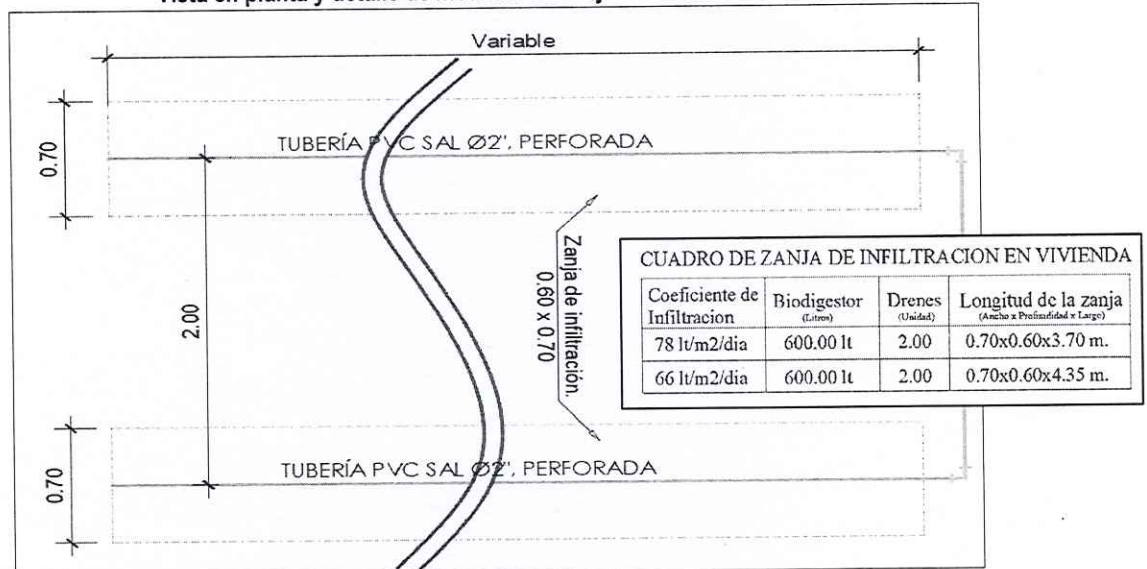
Imagen n° 18: Vista en planta y detalle de medidas de Zanjas de Infiltración.
