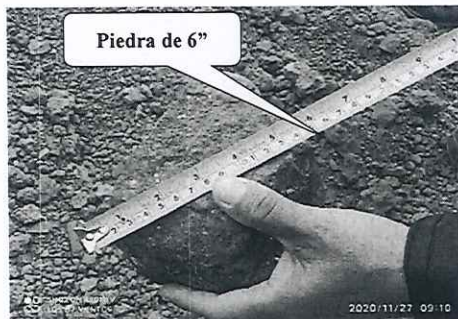
Foto n.º 41: Vista de piedra utilizada para relleno de tubería perforada."
