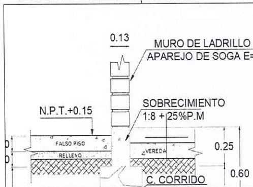
Imagen n° 13: Detalle de corte de Cimentación
